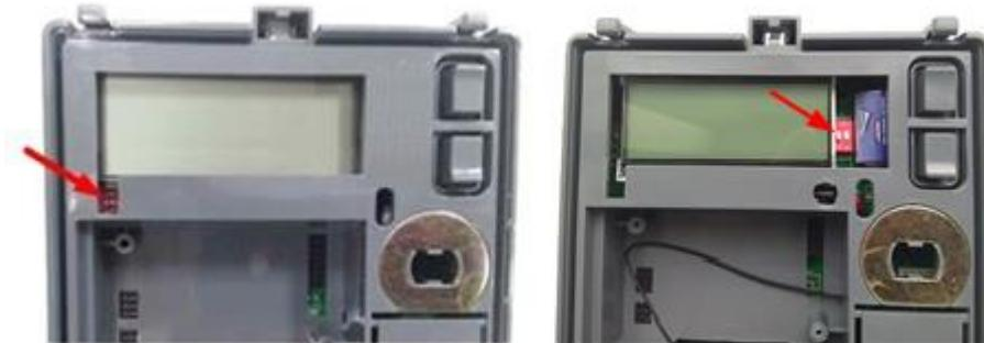
**Рисунок 4.1 – Расположение переключателя блокировки управления нагрузкой счетчика «Меркурий 204»**
