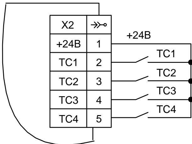
**Рисунок Б.15 – Схема подключения дискретных входов модуля телемеханики счетчика «Меркурий 234»**
