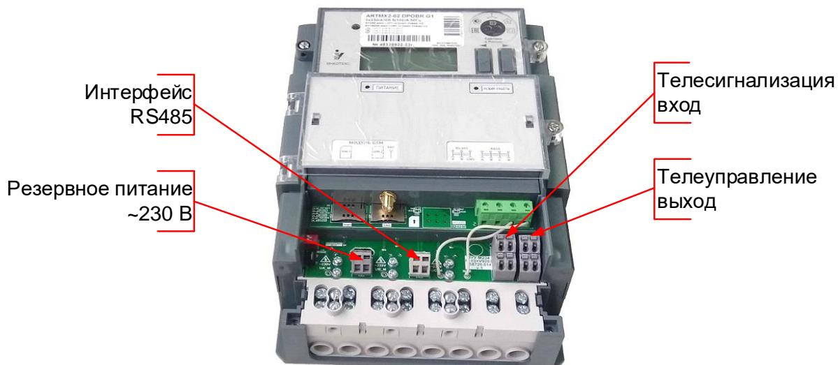
**Рисунок 5.5 – Элементы подключения счетчика «Меркурий 234» с индексом «Х»**
