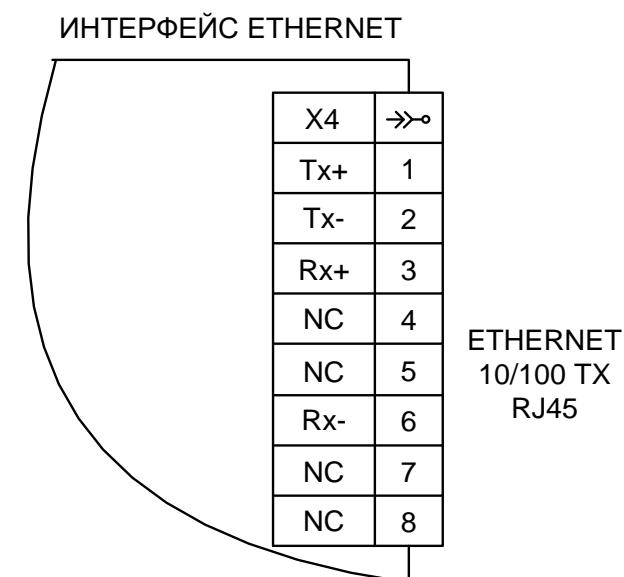
**Рисунок Б.14 – Схема подключения интерфейса Ethernet модуля телемеханики счетчика «Меркурий 234»**
