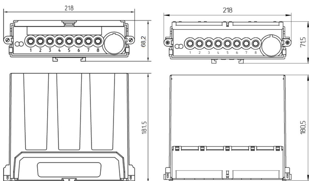
**Рисунок А.5 – Габаритный чертеж счетчика «Меркурий 238»
