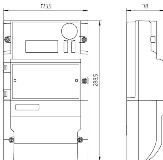
**Рисунок А.4 – Габаритный чертеж счетчика «Меркурий 234»
