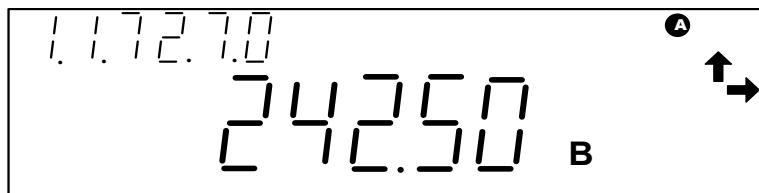
**Рисунок 5.13 – Отображение значения напряжения по фазе А**
