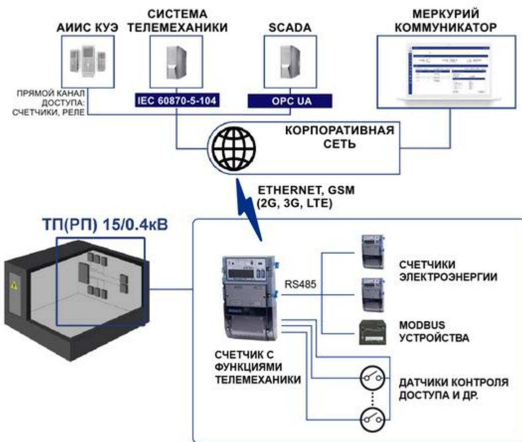
**Рисунок 4.3 – Схема работы в составе автоматизированных систем**
